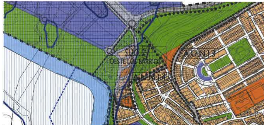
Imagen del Sector de Suelo Urbanizable SUO-2, Oeste de Los Barrios del PGOU de 2008, afectadas por la Llanura de Inundación (T=500) del Río Palmones.
