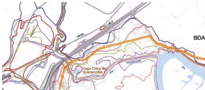
Imagen del Plano de Inundabilidad del Estudio hidráulico hidrológico de la Cuenca del Río Palmones en el ámbito del Sector SUS-6. Nueva Entrada a Palmones
